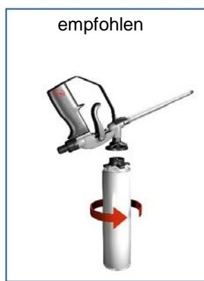
Wenn die Pistole auf eine aufrecht stehende Kartusche gedreht wird, kann beim aufschrauben kein PU-Schaum aus dem Ventil austreten.
