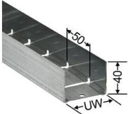
Rigips U-Profil UW/VR ist ein leistungsfähiges Systemprofil von Rigips, welches speziell zur Erstellung von runden Wänden mit CW-Profilen in Rigips Gipsplattensystemen dient. Rigips U-Profile UW/VR entsprechen den Vorgaben der DIN 18182-1 und der DIN EN 14195. Sie werden aus weichen, nicht legierten Stählen mittels Kaltverformung gefertigt. Rigips Profile sind gemäss Rigips Verarbeitungsrichtlinien Trockenbau zu verarbeiten.
