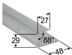
Rigips U-Anschlussprofile UAP 29 sind leistungsfähige Systemprofile von Rigips, welche zur Erstellung von Unterkonstruktionen in Rigips Gipsplatten-systemen dienen. Rigips UAP 29 entsprechen den Vorgaben der DIN 18182-1 und der DIN EN 14195. Sie werden aus weichen, nicht legierten Stählen mittels Kaltverformung gefertigt. Rigips UAP 29 sind gemäss Rigips Verarbeitungsrichtlinien Trockenbau zu verarbeiten.
