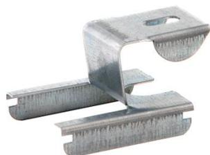
Rigips Halter / CD-Clips dienen zur Befestigung von Rigips C-Deckenprofilen 60/27 an Stützen und Trägern bei der Ausführung von Bekleidungen mit Unterkonstruktion. Der Halter / CD-Clip wird hierbei auf die Flansche des Stahlprofils aufgeschoben und hält über die Klemmung dauerhaft und sicher. Der Klemmbereich liegt bei 11 bis 17 mm. Das C-Deckenprofil 60/27 rastet bei Montage in die Aufkantungen des Halters / CD-Clips ein. Rigips Halter / CD-Clips bestehen aus feuerverzinktem Stahlblech.
