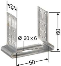
Rigips Justierschwingbügel UW dienen zur rückwärtigen Befestigung von Holzlatten oder Rigips UW (CW) 50 Profilen in Vorsatzschalen und Wandbekleidungen. Die Öffnungsweite des Bügels ist auf die Abmessungen des Rigips UW bzw. CW Profils und auf eine 50 mm breite Holzplatte abgestimmt. Die seitlichen Schenkel verfügen über Rund- und Langlöcher, um das Profil bzw. die Holzplatte zu befestigen. Die Verankerung des Rigips Justierschwingbügels erfolgt über die Öffnungen in der Basis des Bügels.
