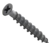
Gips-Gipsschrauben GGS dienen zur Befestigung von Bekleidungen auf Wände und Decken in Rigips Gipsplattensystemen. Gips-Gipsschrauben GGS werden aus Stahl gefertigt und entsprechen den Vorgaben der DIN EN 14566. Sie verfügen über einen Trompetenkopf, ein Grobgewinde und eine Nagelspitze. Sie werden zur Befestigung von Gipsplatten auf Gipsplatten verwendet.
