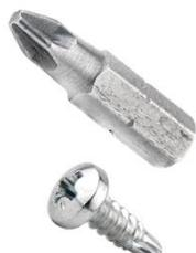
Bohrschrauben BS 7220 dienen zur Verbindung (Blech auf Blech) von Unterkonstruktionen in Rigips Gipsplattensystemen. Bohrerschrauben BS 7220 werden aus Stahl gefertigt und verfügen über einen Linsenkopf, ein Feingewinde und eine Bohrspitze. Sie werden zur Verschraubung von Blechen  $\leq 2.0$  mm verwendet.
