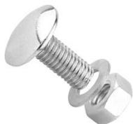
Flachrundschrauben M8 (Schlossschrauben) dienen zur Verbindung (Blech auf Blech) von UA-Profilen mit Anschlusswinkeln in Rigips Gipsplattensystemen. Flachrundschrauben M8 werden aus Stahl gefertigt und verfügen über einen Flachrundkopf, ein Feingewinde sowie eine Unterlegscheibe und eine Sechskantmutter.
