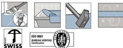
Solprotec™ bietet temporären Oberflächenschutz frisch verlegte Parkett-, Ton-, Keramik- und Steinböden. Es kann leicht zugeschnitten werden. Das Vlies ist einfach zu reinigen und wiederverwendbar, so lange die rückseitige Beschichtung unbeschädigt und frei von Schmutz und Staub ist.
