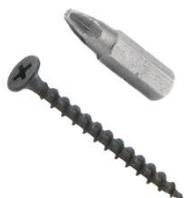
Rigips-Schrauben TNH dienen zur Befestigung von Bekleidungen auf Wände und Decken in Rigips Gipsplattensystemen. Rigips-Schrauben TNH werden aus Stahl gefertigt und entsprechen den Vorgaben der DIN 18182-2 sowie der DIN EN 14566. Sie verfügen über einen Trompetenkopf, ein Grobgewinde und eine Nagelspitze. Sie werden zur Befestigung von Gipsplatten auf Holzlatten verwendet.
