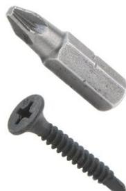
Rigips Selbstbohrschrauben TB dienen zur Befestigung von Bekleidungen auf Wände und Decken in Rigips Gipsplattensystemen. Rigips-Selbstbohrschrauben TB werden aus Stahl gefertigt und entsprechen den Vorgaben der DIN 18182-2 sowie der DIN EN 14566. Sie verfügen über einen Trompetenkopf, ein Blechschraubengewinde und eine Bohrspitze. Sie werden zur Befestigung von Gipsplatten auf Metallunterkonstruktionen aus Stahlblech von  $\geq 0.7$  mm bis  $\leq 2.0$  mm verwendet.
