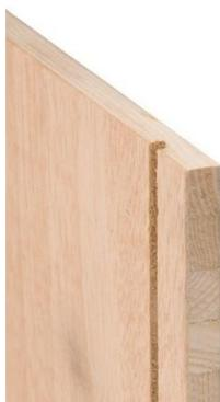
Rigips Tischlerplatte mit beidseitiger, dekorativer Melaminharzdirektbeschichtung im Zweiblattaufbau. Mittellage aus harnstoffverklebter Stabplatte (IF 20 nach DIN 68705), abgesperrt mit einem Spandeck.
